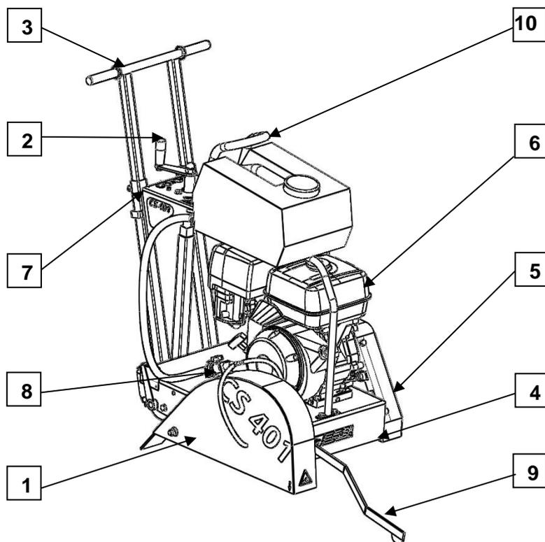
Faite d'acier profilé soudé, la CS 401 est à la fois stable lors de la coupe et facilement transportable.
