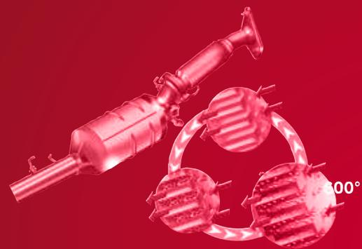
Le FAP (Filtre à Particules Diesel) est maintenant de série sur tous les moteurs EURO5B+. En réduisant drastiquement le nombre de particules relâchées, il rend vos trajets bien plus écologiques. Il existe deux modes de régénération : l'Auto-régénération et la Régénération Manuelle (via un interrupteur sur le tableau de bord).
