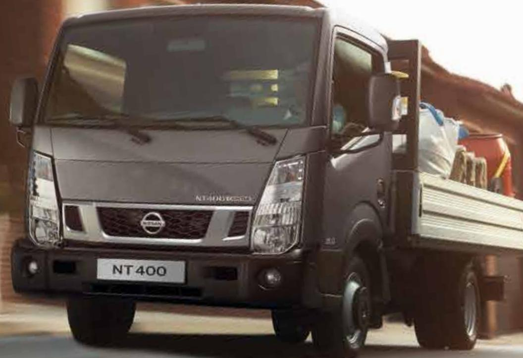
**LE YD25 2,5 LITRES** développe 121ch / 250Nm pour les modèles avec 3,2T et 3,5T de PTAC.
