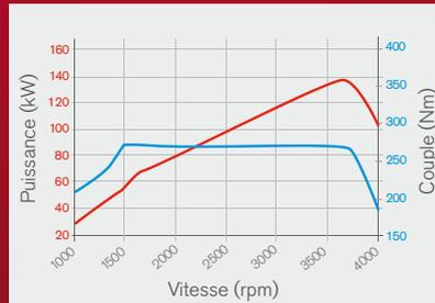
**LE YD25 2,5 LITRES** développe 145ch / 350Nm pour les modèles avec 3,5T et 4,5T de PTAC.
